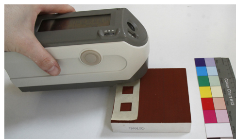
Obr. 7 Metoda měření optické změny pomocí Spektrofotometru. Foto: Petra Zítková
