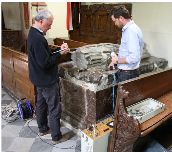
Obr. 2 Restaurátorský průzkum – měření ultrazvukové transmise. Foto: Univerzita Pardubice, Fakulta restaurování.
