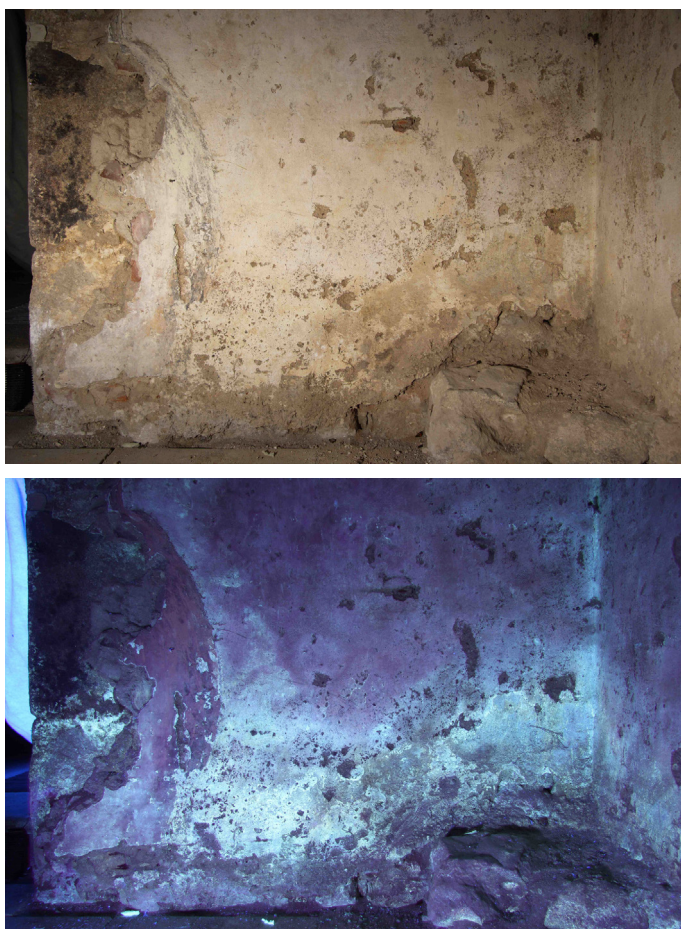
Obr. 8 Příklad srovnání fotografie pořízené v bílém umělém osvětlení a UV fluorescenční fotografie středověkých omítek zasažených působením vodorozpustných solí. Čelní stěna vítězného oblouku, jižní část, kostela sv. Víta v Zahrádce u Ledče nad Sázavou. Foto: Ivana Studeník Milionová.
