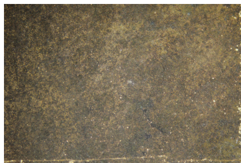
Obr. 13 a 14 Ukážka modelovej vzorky zo zliatin medi pred (hore) a po (dole) čistení skleneným vláknom v kombinácii s demineralizovanou vodou. Fotografia z optického mikroskopu Leica S6D. Foto: Marianna Glušťiková.
