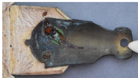
Obr. 11 Galvanický článok v mieste fixácie. Spona zo zliatiny medi je fixovaná železným nitom. Sign. I E 9. Foto: Marianna Gluščíková.
