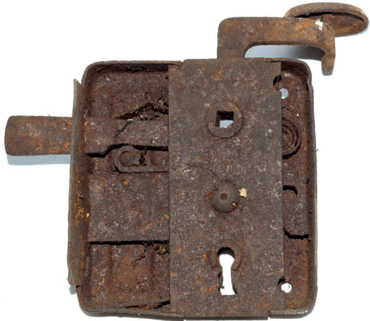
OBR. 2 Levý zámek ze zadní strany (před repasí). Foto: Jan Jeníček
