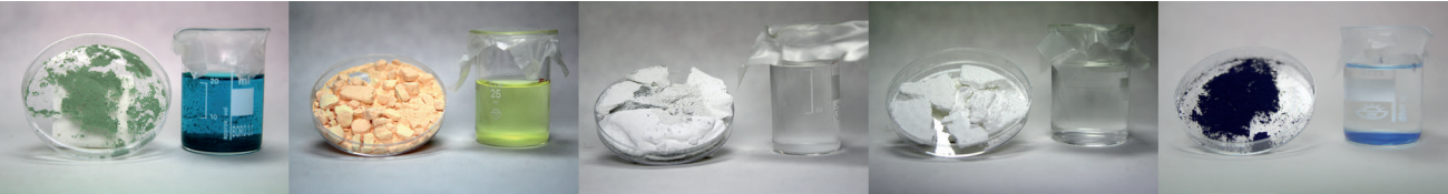
OBR. 3 Produkty reakcí pigmentů s 10% roztokem kyseliny citronové (zleva: malachit, minium, masikot, kremžská běloba, berlínská modř). Foto: Ondřej Limpouch
