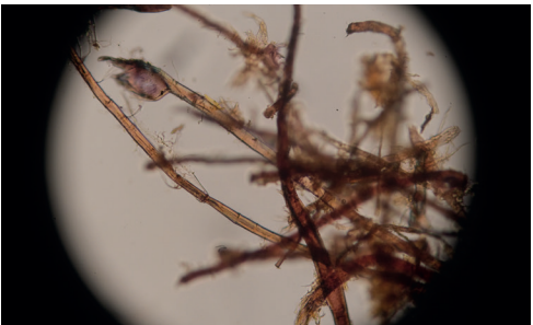
OBR. 7 Digitálny záznam. Chemický rozbor vlákien; Graff C; priblíženie 200x. Autor: Zuzana Machatová
