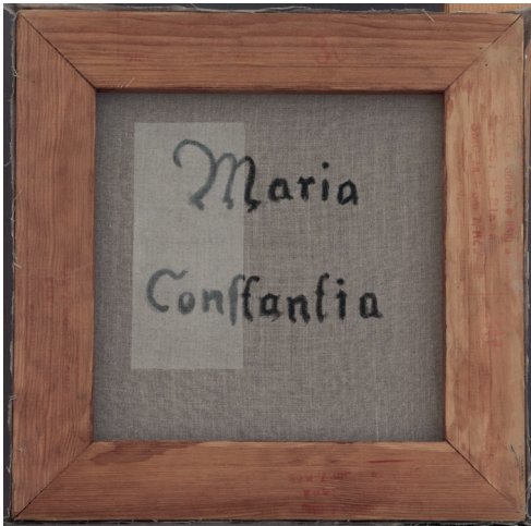
Obr. 6 Zkouška transparentnosti hedvábné krepeliny a adheziva BEVA 371 Film. Foto: Dominika Medová
