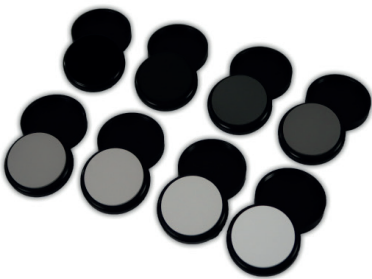
Obr. 5 Vybrané kalibrační tabulky a standardy: a) tabulka AIC PhD Target (AIC, nahore); b) tabulka s referenčními cíli X-Rite ColorChecker Passport Photo 2 ; c) difúzní odrazivé černo-bílé standardy Spectralon (Labsphere) s grafy závislosti jejich odrazivosti ( 0^\circ Hemispherical % reflectance) na vlnové délce ( Wavelength nm ). Obrázky: AIC, X-Rite a Labsphere [31]
