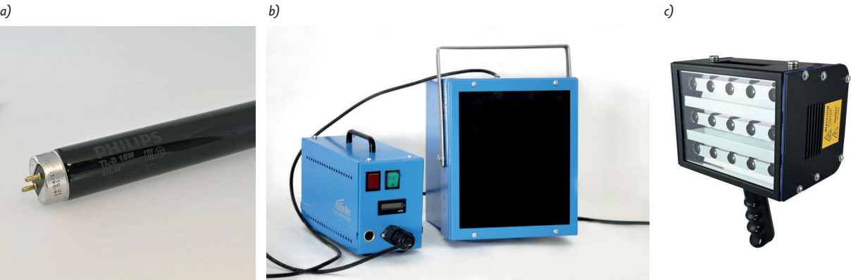
Obr. 3 Základní typy UV zářičů: a) UVA zářívka s nízkotlakou rtuťovou výbojkou; b) vysoce výkonný zářič s vysokotlakou rtuťovou výbojkou a předřadníkem (na snímku s filtrem propouštějícím UVA záření 315–400 nm); c) zářič s několika UVA LED. Foto: Deffner & Johann, Petra Lesniaková, Hönle UV Technology 17
