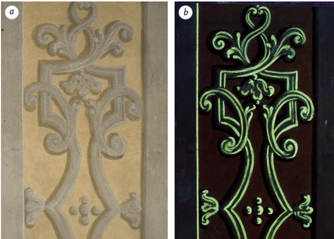
Obr. 6 Příklad využití UV fluorescenční fotografie, nástěnná malba nad východní částí hudebního kůru v kostele sv. Petra a Pavla v Rajhradu: a) snímek v rozptýleném bílém světle (VIS); b) ultrafialová fluorescenční fotografie (UVF). Na UV fluorescenční fotografii (8b) jsou zvýrazněné partie, ve kterých byla použita zinková běloba. Vyznačují se zeleno-žlutou UV fluorescencí charakteristickou právě pro tento pigment. Autoři: David Svoboda, Jan Vojtěchovský
